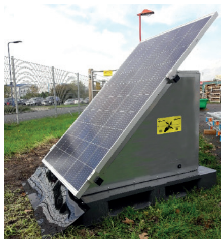
Figur 3.1: PVC-stribpen sørger for, at der ikke falder skygge på solcellen på grund af plantevækst.
