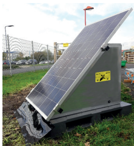
Figur 3.1: PVC Streifen schützt gegen Beschattung des Solarmodules
